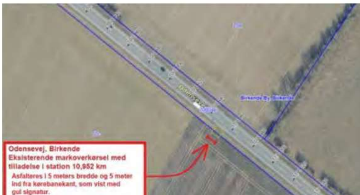
Figur 7-5 Kerteminde Kommunes krav til overkørsel til Odensevej.
